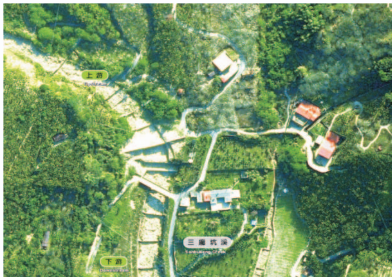
上安土石流觀測站儀器安裝位置圖
