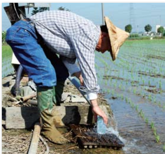
▲圖37. 取水樣檢測水質（導電度）
