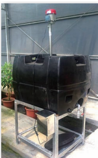
圖3. 本場目前已利用簡易式醱酵設備進行液化澱粉芽孢桿菌BaKH445菌株之量產。
