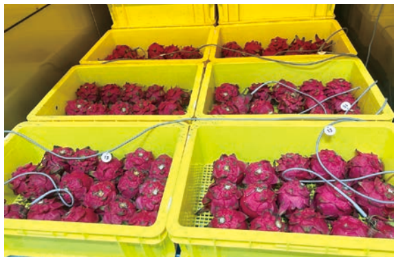
紅龍果插溫度探針監測果心溫度
