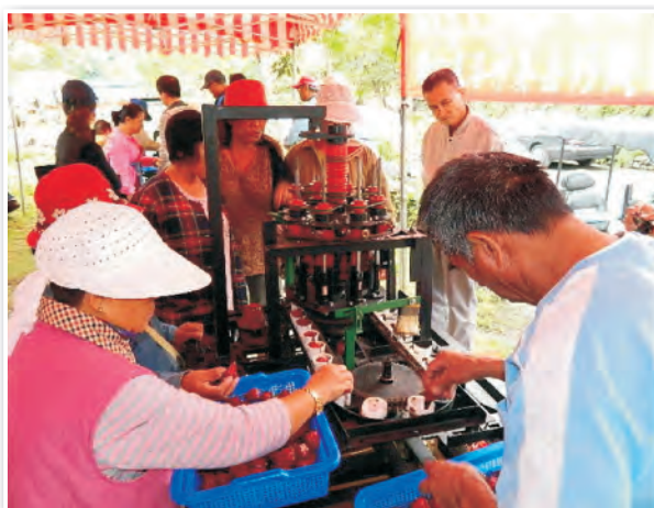
圖4. 洛神葵去籽機省工好用有效率農友親身體驗操作去籽機械
