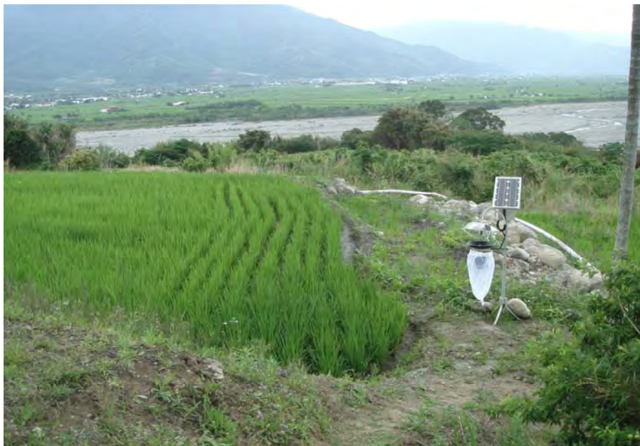
圖 2. 有機水稻田安裝吸入式太陽能捕蟲器捕蟲
