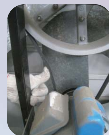
步驟五 檢查皮帶鬆緊度
