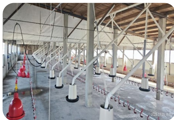
▲ 引導生產管理智動化，輔導家禽畜牧場導入自動化飲水線與餵飼線系統
