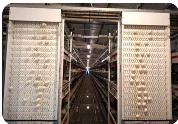
▲ 蛋雞舍裝設直立式自動化集蛋系統，減輕養禽農民勞力負擔，提高生產效率
