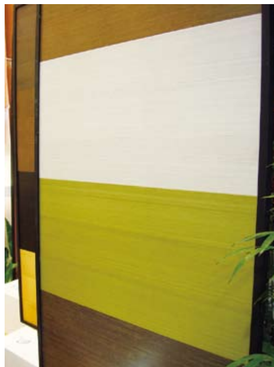
利用機器平切竹材成「竹薄片」，目前已突破可達0.04 cm厚度，透過著色技術可增加色彩多元性，提昇竹製品美觀與耐久性(林裕仁 攝)
