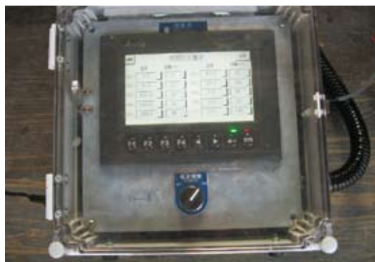
圖6 具資料數位顯示、即時分析繪圖功能與擴充網路寬頻遠端傳輸介面等功能之數位溫度顯示記錄器(黃國雄 攝)
