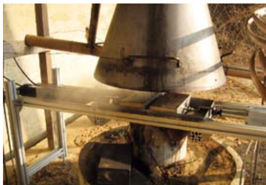
圖5 置於煙囪口調控排煙孔隙之PID自動開關閥(黃國雄 攝)
