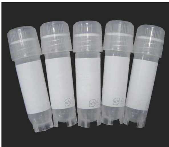
圖四、將菌絲塊放入可耐低溫的冷凍保存管中，再加入抗凍劑如海藻糖或甘油，可以在-20°C或-80°C作中長期之保存。
