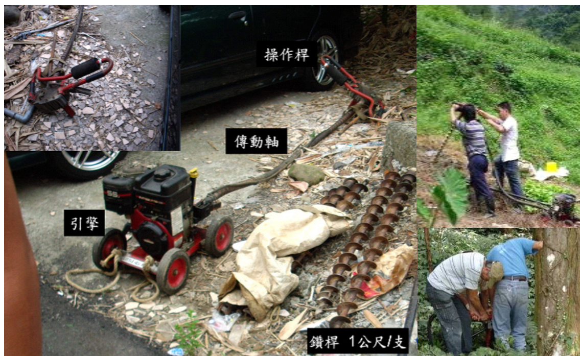
圖 4-2.2 機械傳動式土鑽調查方式
