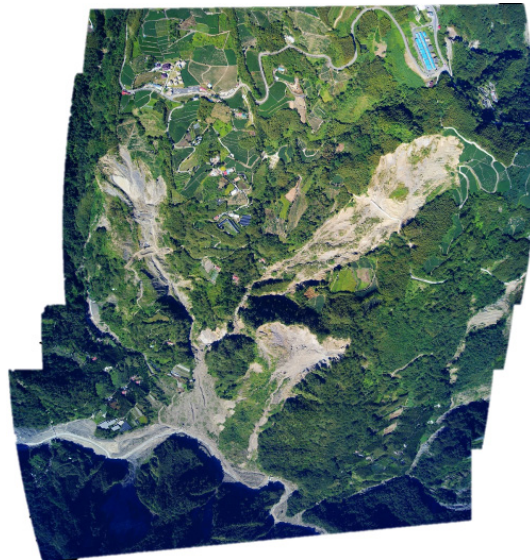
(a) 莫拉克災後空拍：崩塌面積大且道路遭受阻斷 (摘自 水保局，2010 a )
