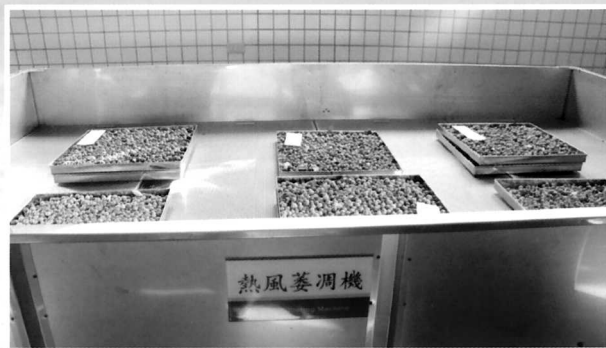
小果油茶使用熱風機試驗情形
