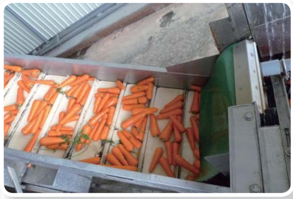
圖13. 通過水柱清洗後外觀
