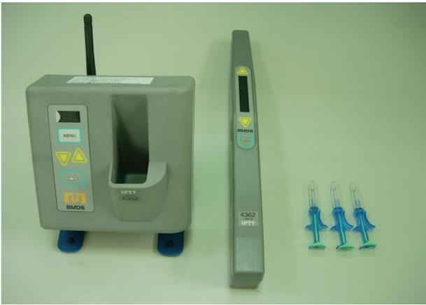
圖 1、手持式晶片讀取系統，由左至右分別為基座、讀取器、微晶片植入器套組（內含微晶片）。
