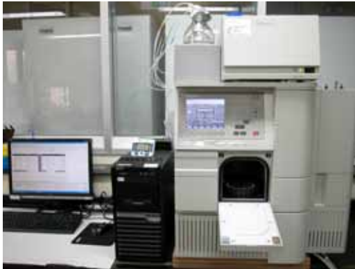
圖 1、防腐劑含有量試驗，以高效液相層析儀進行分析。
