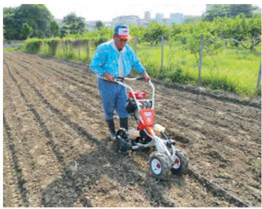
圖1. 中耕機附掛式播種機播種小米
