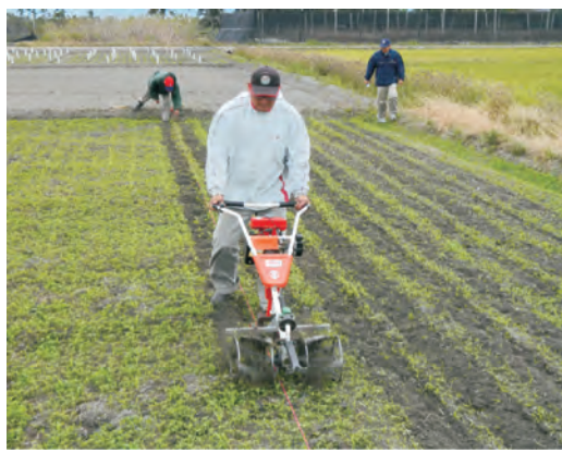
圖2. 中耕機採用40公分除草輪進行小米田間除草
