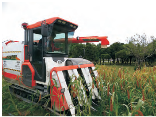
圖4. 水稻聯合收穫機進行小米一貫化採收試驗
