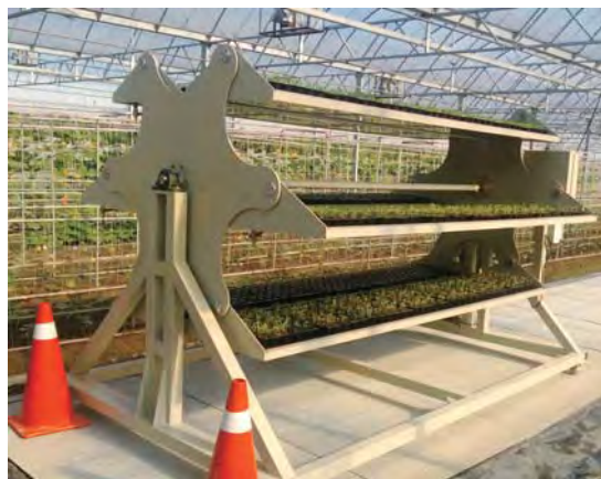
▲試製完成之迴轉懸吊盤式栽培架
