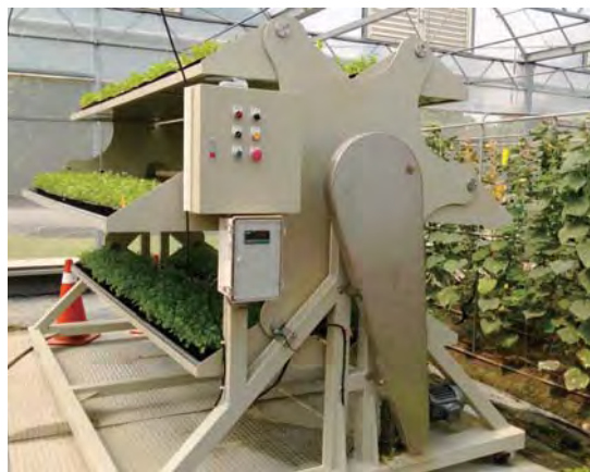
▲馬達傳動裝置與電控箱系統
