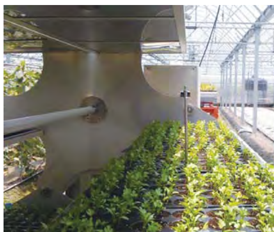
▲懸吊承盤上以感測器收集溫度及照度資料
