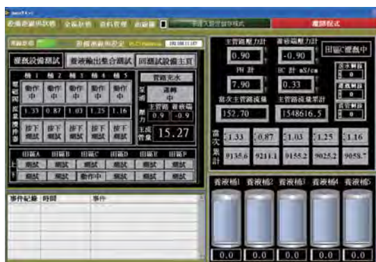
圖6 PC-based 肥灌監控系統遠端控制灌溉啟動與停止
