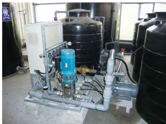
圖1 自動施肥灌溉系統之組成外觀
