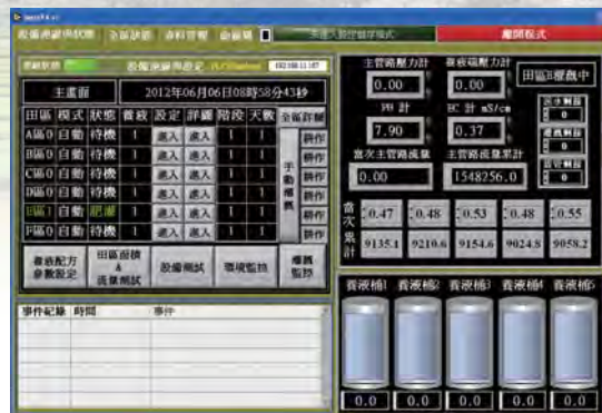
圖4 遠端監控肥灌系統網路之PC-based監控畫面
