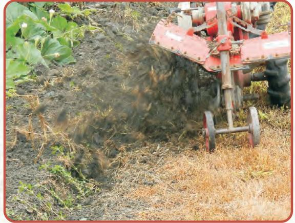
圖2. 中耕機開溝的同時亦將土塊翻耕至前溝上
