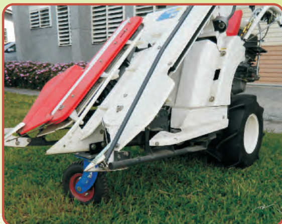
圖3. 改良機體提高收割高度並加裝轉向輪
