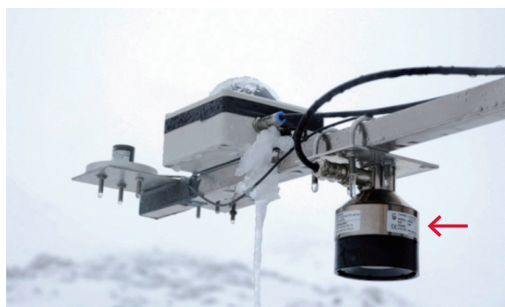
b. 超音波型雪深感應器(箭頭指示) 地點：雪山圈谷氣象站 攝影日期：2011年2月14日 攝影：張譚心
