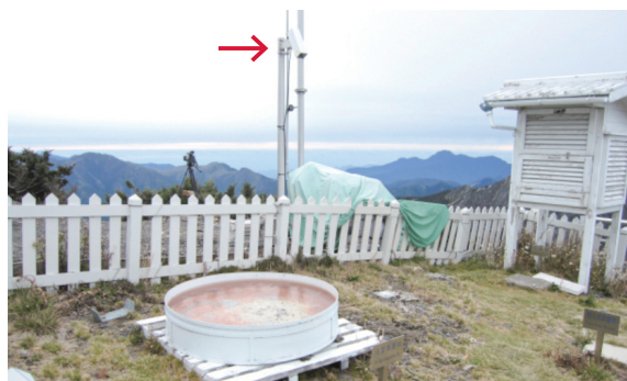
a. 紅外線型雪深感應器(箭頭指示) 地點：玉山氣象站 攝影日期：2011年11月26日 攝影：魏聰輝
