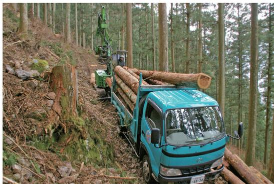
照片3 路幅寬250 cm的作業道，以2噸重四輪傳動車搬運木材。
