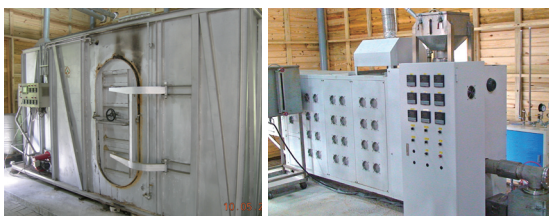
圖2 竹炭模組化與連續式炭化/活化爐(工業技術研究院/六甲院區)
