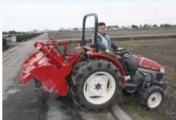
▲曳引機上下田區採前下、倒上較為正確與安全
