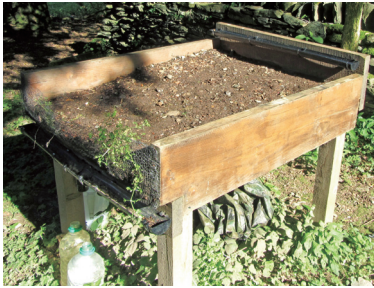
分別模擬三種不同的土地類型(森林底層、農耕地、城市街道)的實驗箱
