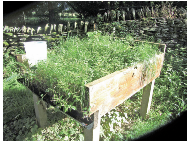
分別模擬三種不同的土地類型(森林底層、農耕地、城市街道)的實驗箱
