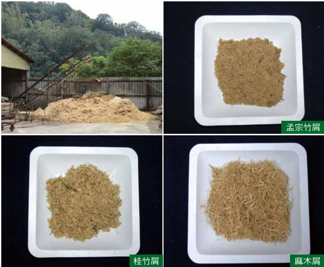
圖三、竹材加工廠(左上)；桂竹屑(左下)；孟宗竹屑(右上)；麻木屑(右下)。
