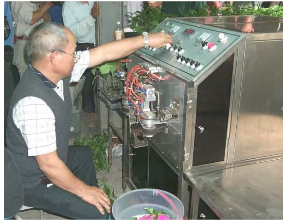
圖七、百香果種苗自動嫁接機單人即可操作全自動嫁接情形及所完成之嫁接苗(右下圖)
