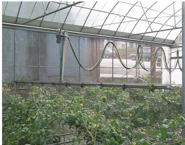
圖十九、裝設於東勢立農育苗場之六連棟溫室用自動換棟型懸吊桿式噴霧系統
