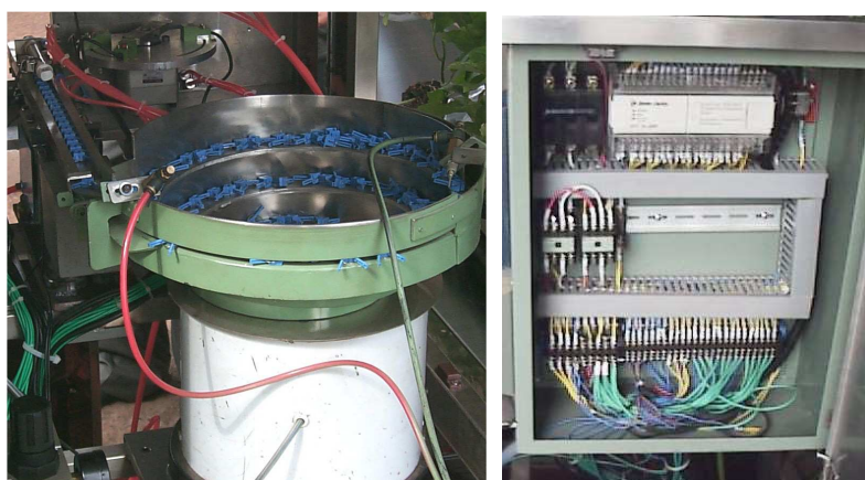
圖六、百香果種苗自動嫁接機嫁接夾振動篩選(左圖)及與直線排列供給可程式控制器與電控箱(右圖)之機構與作業情形
