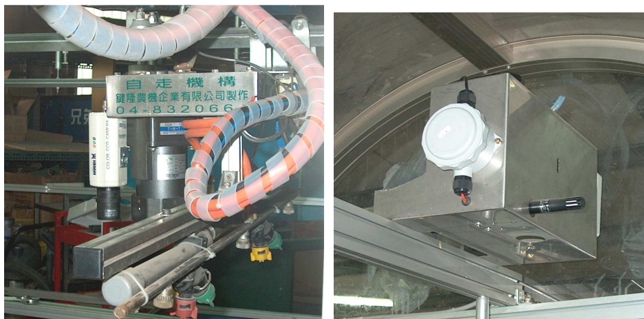
圖二十一、溫室模型中所裝置之取像 CCD 鏡頭與微氣候環境偵測感應器
