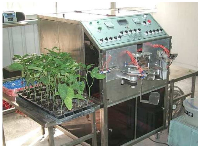
圖二、臺中區農業改良場與中興、嘉義大學等合作試驗研製完成之百香果種苗自動嫁接機外觀
