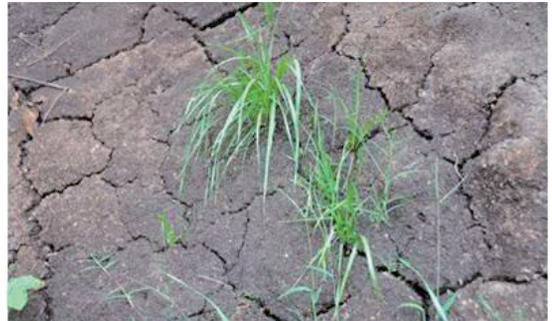
使用菇肥堆肥材料常見噴植基材乾裂收縮情形
