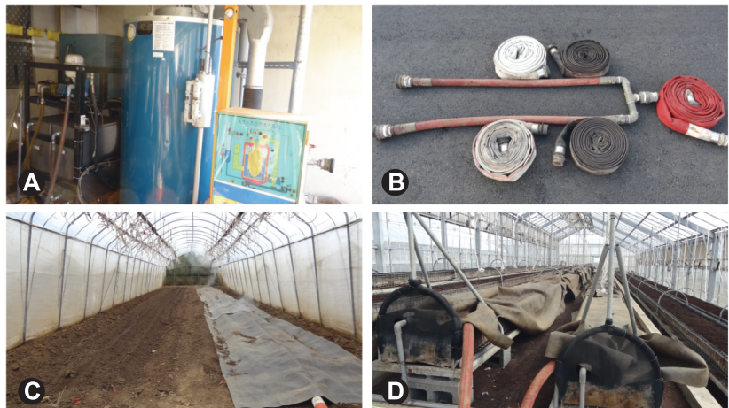
圖1. 土壤蒸氣消毒機 (A)與蒸氣管帶 (B)連結後採上置式覆蓋法消毒(C)、(D)
