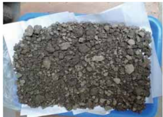
▲將土壤樣本平鋪並放置於室內陰涼處晾乾
