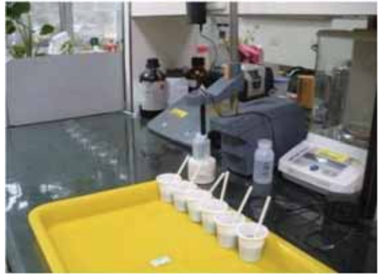
▲土壤浸去離子水靜置1小時，以測定土壤pH值
