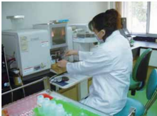
▲樣品溶液用ICP儀器測定
