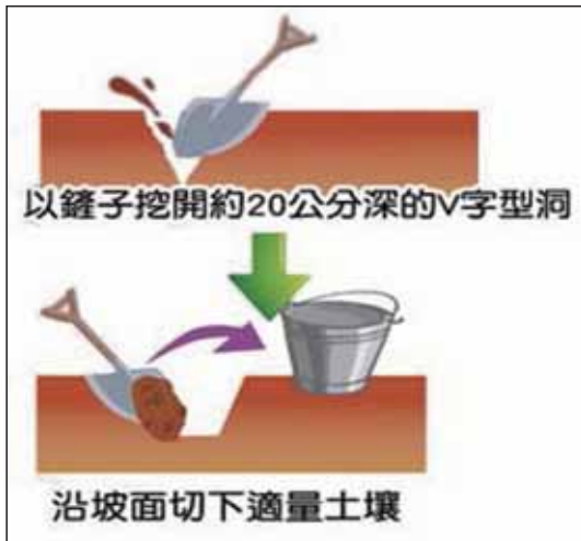
▲挖V字型洞，取樣
