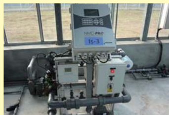
▲直接注入式肥灌系統-進口機種
