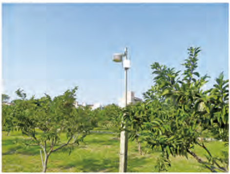
圖 1. 無線焚風感測器田間安裝情形
