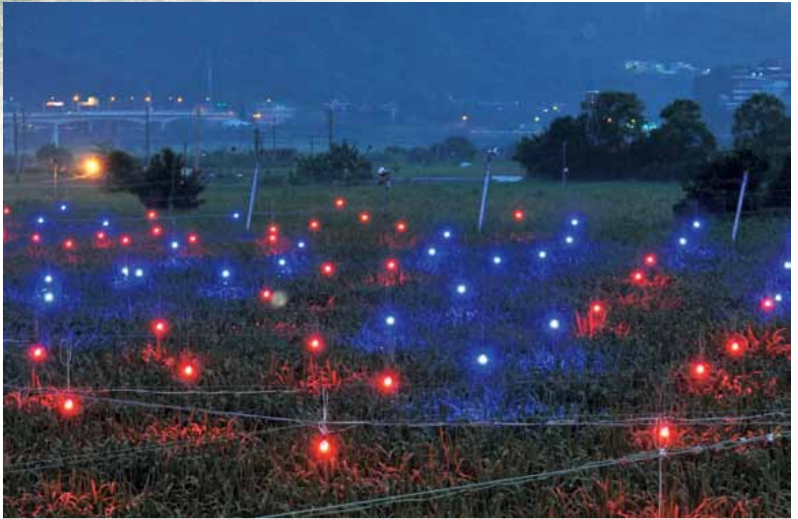
圖二、農業試驗所與工業研究院合作，利用LED燈夜間照光調整茭白筍產期之田間試驗。
