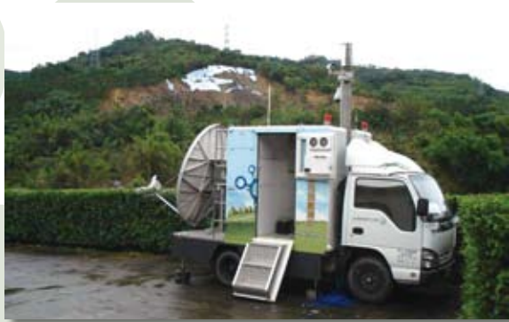
行動式土石流觀測站出動狀況與拍攝影像-07/23鳳凰颱風觀測車架站情形
