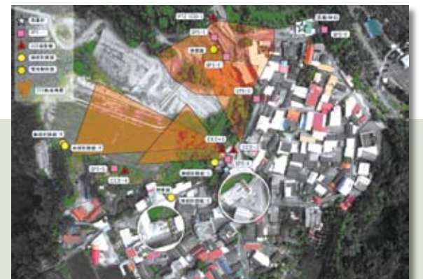
坪頂村崩塌地監測儀器配置圖
