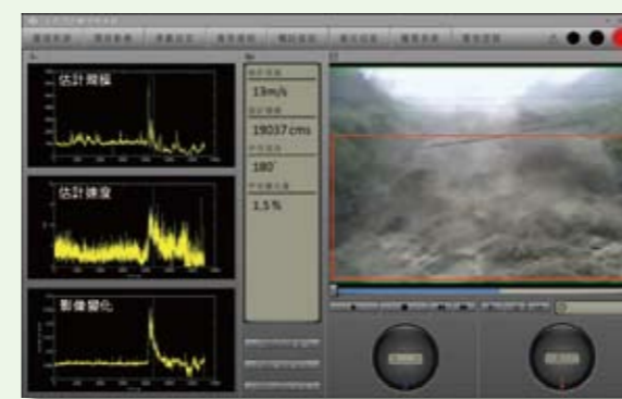
土石流影像分析雛型系統
