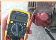
▲電表歐姆檔位檢查ON檔位開關，正常為斷路
