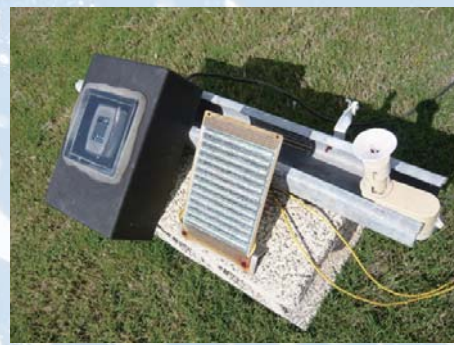
▲三種下雨感測器（左：電子式；中：電阻式；右：重量式）
