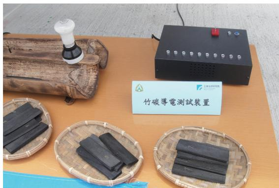
圖 5 竹炭導電測試裝置
