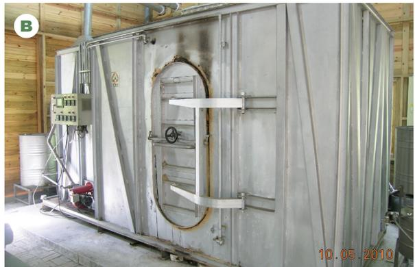
圖 1 竹炭之生產設備：(A) 土窯，(B) 機械窯
