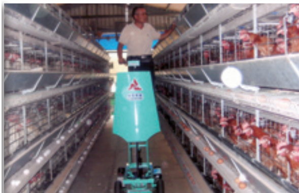
■ 升降作業機於立體雞舍巡場作業
