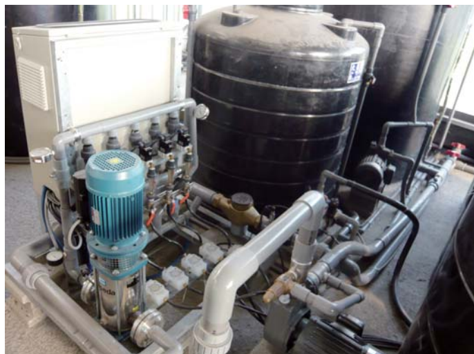
▲ 本場研發技轉之基本型養液自動調配灌溉機具
