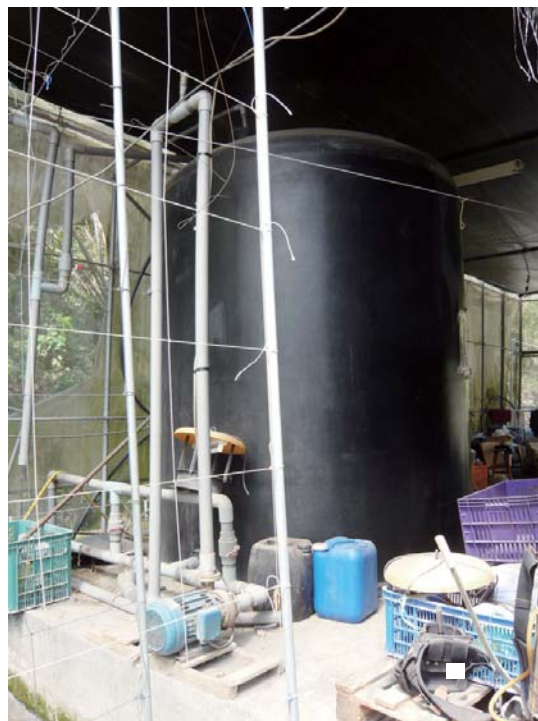
▲ 混合桶肥灌器材是最簡單與低成本的肥灌組合
