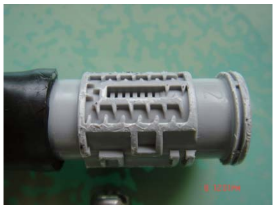
▲ 壓力補償型滴帶內部細小的孔道最怕堵塞
