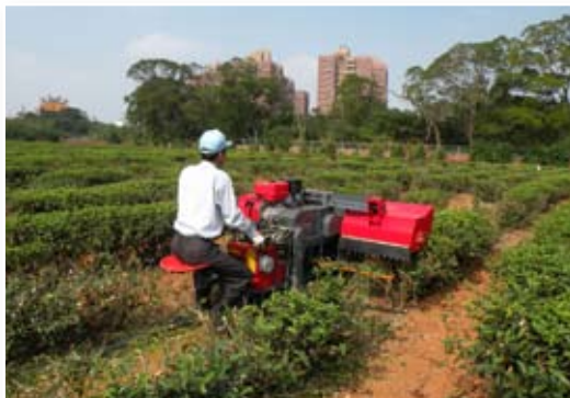
小型履帶式中剪枝機作業情形
