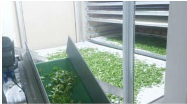
圖一、由層積式熱風萎凋機萎凋之後，以輸送帶送至萎凋層架進行室內萎凋
