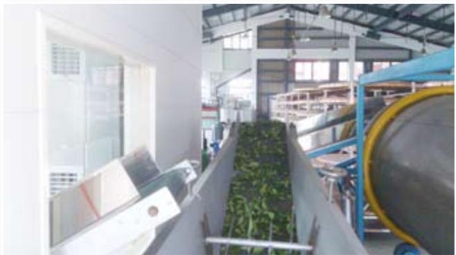
圖二、再以輸送帶送入自動傾卸攪拌機(圖右側)；俟攪拌完成後再輸送回萎凋層架上
