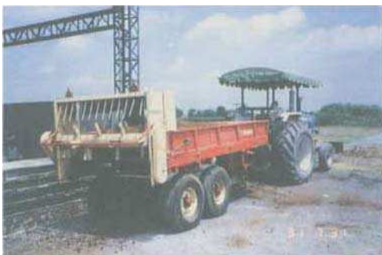
圖1. 水平撒佈軸式撒佈機 日製STAR牌，由曳引機拖載，P.T.O.傳動，開放式，後向撒佈。
