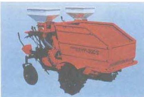
圖11. 自走式堆肥挖溝施肥機 日製SUN牌，自走動力，開溝施入，堆肥桶容量460公升，3.6km/hr。
