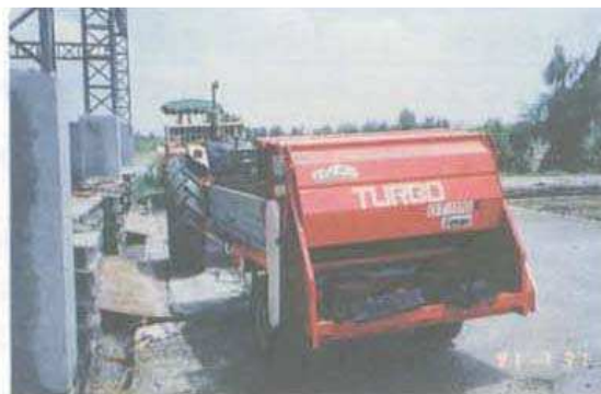
圖4. 盤式堆肥撒佈機 日製SASAKI牌，並用式(三點連接+拖桿)拖載，P.T.O.傳動，後向撒佈。
