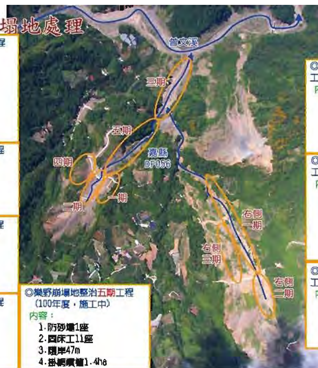
圖15 樂野崩塌地處理工程配置圖
