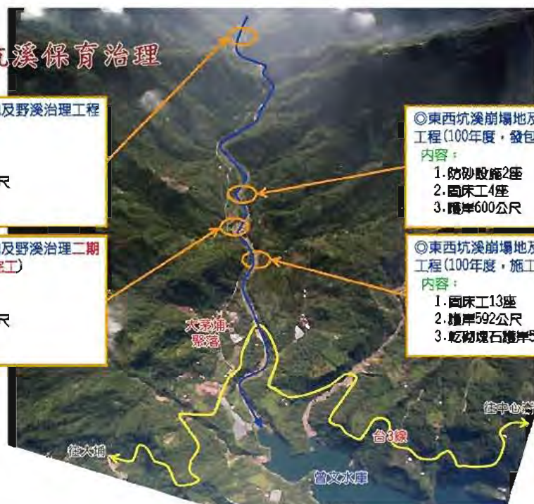
圖13 東西坑溪保育治理工程配置圖
