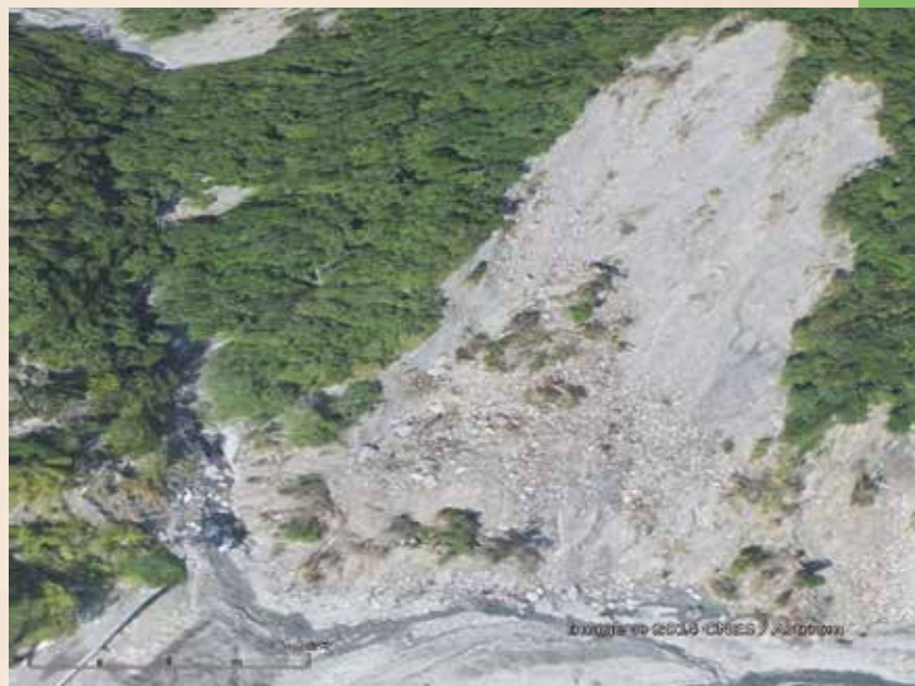
圖三、民國103年9月鳳凰颱風過後，臺東縣卑南鄉知本村無人飛行載具空拍照片，經嚴密之幾何糾正與地理定位處理後，（上）在多尺度遙測空間資訊系統上展示的成果。（下）選擇適當視角並聚焦在主要的一處崩塌地上，可清楚呈現災害現況。
