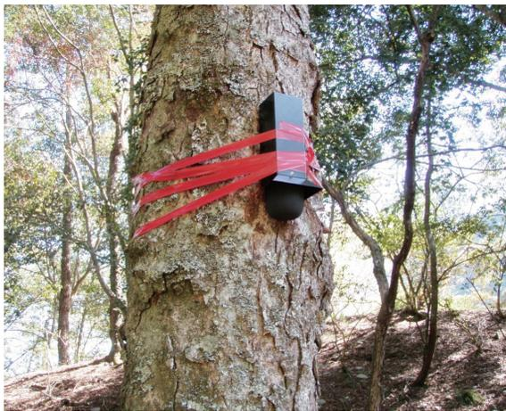
▲圖1、林務局森林資源調查隊使用之長時間錄音調查設備與架設方式
